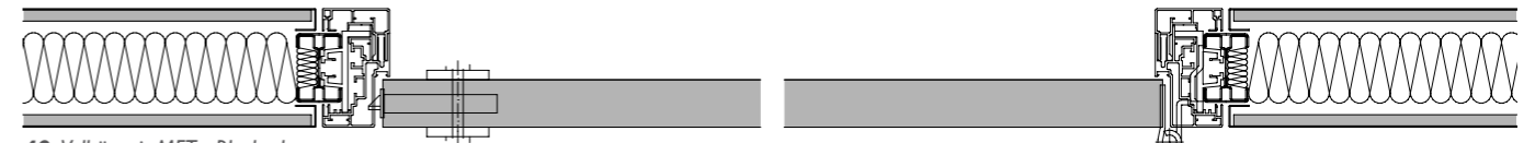
40 Volltür mit MFT - Blockrahmen Solid door with MFT block frame
